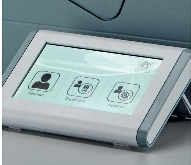
Вверху: сенсорный экран делает управление системой интуитивно понятным и простым благодаря графическому интерфейсу пользователя; для удобства оператора положение экрана может быть легко отрегулировано.
